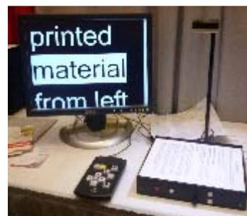
処理系は厚みのある原稿台に組み込まれていた。原稿台のサイズが A 4 大になっており、ガイドも備わっていて原稿をカメラに対して水平に置くことができるようになっていた。
