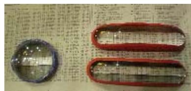
右図の写真はMaxiAids社製のMAGNIFICO PLUSという拡大鏡である。板から伸びた2本の支柱にレンズが取り付けられているといった見慣れない形状をしている。これはPDAやGPSなどの携帯端末を拡大するために作られた拡大鏡である。支柱の角度と、レンズの角度及び高さをそれぞれ操作でき、ねじで固定することができるため、様々な携帯端末に対応できそうであった。残念なことに会場に携帯端末がなかったためMAGNIFICO PLUSのみの写真を掲載した。
