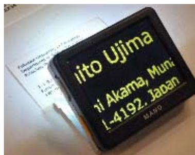
パンニングは、MANO を机において上下左右に動かすと、それに同調して画像が本体を動かしたのと同じ方向にスクロールされるようになっており、小型画面による視界の狭さを補う工夫が施されていた。
