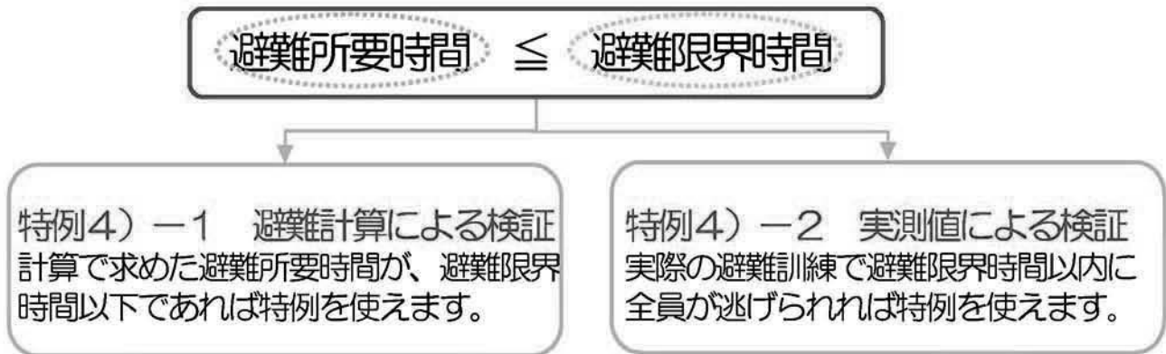
図7. スプリンクラー免除規定 (特例4)
